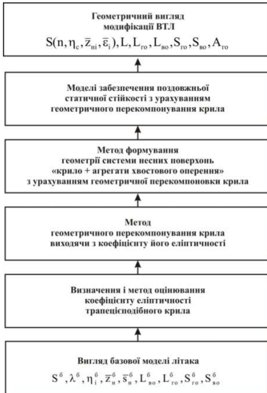
Рисунок 2.8 – Методи та моделі оцінки модифікаційних змін при геометричному перекомпонуванні крила
